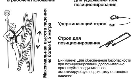
Внимание! Для обеспечения безопасности при позиционировании дополнительно организуйте соединительно-амортизирующую подсистему остановки падения
