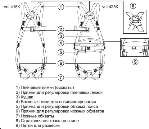
Рис. 2. Типы крепежных точек
